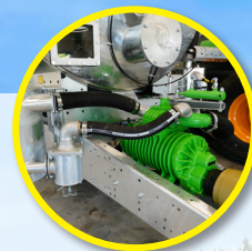
Pompa próżniowa (11000 l/min) lub pompa ślimakowa (3666 l/min)
